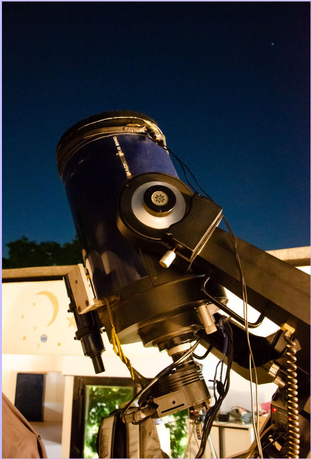
Telescopio Meade 250 LX200 de 10 pulgadas de diámetro y cámara CCD ST9E, parte del equipo utilizado para la medición de asteroides y cometas.
