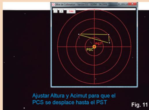
Cabe señalar que, si el método *Star Trail* se inicia con la montura muy fuera de estación, puede suceder que el PSC no aparezca en las imágenes. Si este fuera el caso, luego de realizar el *Star Trail* se pueden realizar un par de ajustes gruesos por el método de *Deriva Polar* hasta lograr que PSC aparezca en la imagen y a partir de allí retomar el método *Star Trail*.
