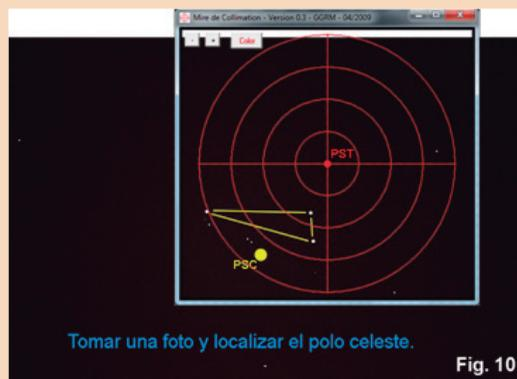
Finalmente, se ajustan altura y acimut para lograr que el PSC se desplace hasta el centro de la retícula. Para hacerlo, entre ajuste y ajuste, se van tomando fotografías de un par de segundos de exposición; de manera que se verá el desplazamiento del PSC que se consiguió con cada ajuste. La puesta en estación estará terminada cuando se haga coincidir el PSC sobre el PST (Fig. 11).
