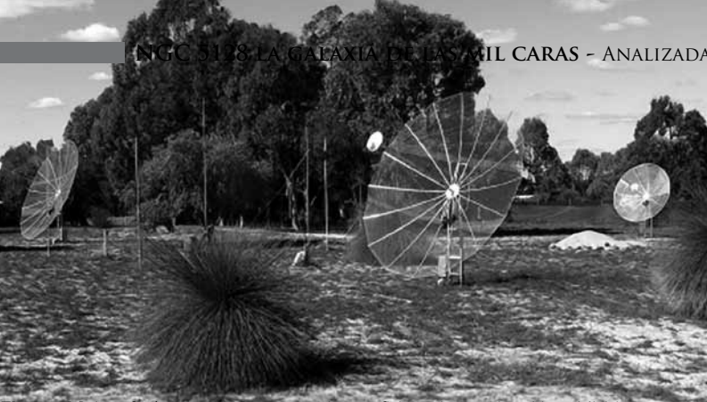
Figura 16. Interferómetro de 3 antenas de un aficionado y amigo, Hans Michimayr, que opera en Guilderton, Australia. Con él puede detectar innumerables radiofuentes, entre las cuales está la intensa CenA, a 14 millones de años luz.
