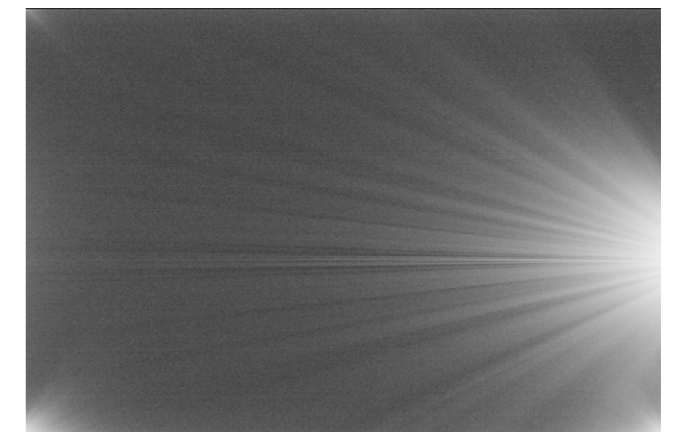
Ruido típico de amp glow de una cámara ZWO ASI 183.
